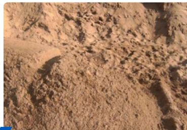
CÁT VÀNG HẠT LỚN ĐỔ BÊ TÔNG
