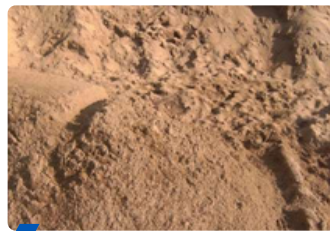
CÁT VÀNG HẠT LỚN ĐỔ BÊ TÔNG
