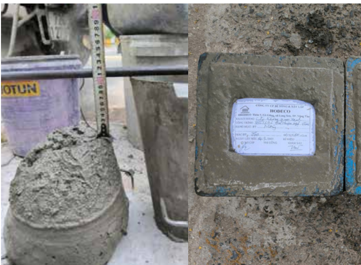
Hình ảnh: Kiểm tra cấp phối-độ sụt
