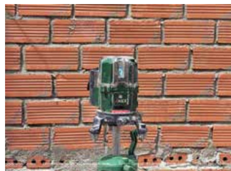
Hình ảnh: Ghém tường bằng laser
